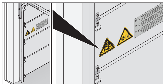
Obr. 1.2 Umístění nálepek na křídle vrat
