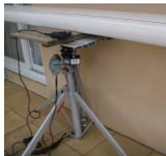
4 teleskopické nohy umožňují použití v nerovném terénu a těsně u zdi
