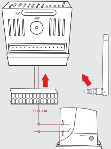
Zapojte signálový kabel (minimálně 2x 0,35 mm<sup>2</sup> Cu) mezi svorky O1A-O1B GSM Klíče a svorky START Vašeho pohonu brány.
