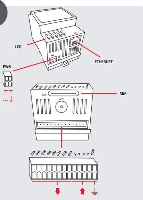
Popis rozhraní a zapojení napájecí svorky, výstupní a vstupních portů je uvedeno na obrázku.
