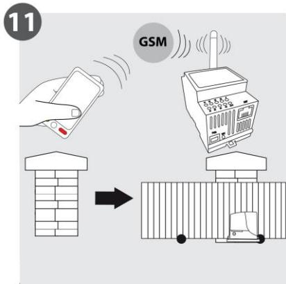
**GSM Klíč PROFI 3** je aplikace sloužící k ovládání elektrických pohonů brán, závor a vrat mobilním telefonem. Otevřání a zavírání je ZDARMA a je uskutečněno tzv. prozvoněním telefonního čísla SIM karty umístěné v zařízení.
